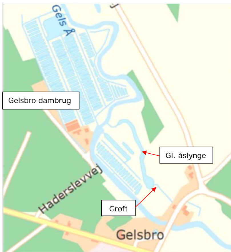
Figur 2.4.2: Afvandringsgrøft der på projektstrækningen har udløb til Gels Å via den gamle åslynge. ( Baggrundskort fra Arealinfo.dk)
