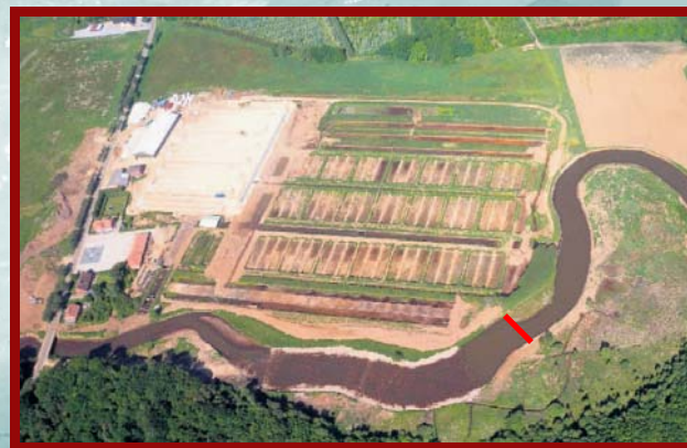
Samtidigt med Snæbelprojektets gennemførelse blev dambrugets moderniseret, så vandet nu pumpes ind fra åen. Dermed blev opstemningen overflødig og kunne fjernes. (den røde streg viser, hvor opstemningen tidligere lå. (Foto: JyskeVestkysten)
